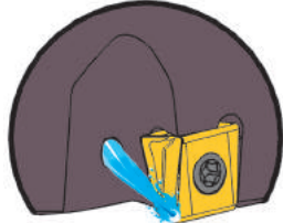
Внутренняя подача СОЖ при обработке стали и нержавеющей стали
