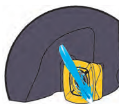
Внутренняя подача СОЖ при обработке аустенитной нержавеющей стали и титановых сплавов
