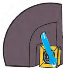
Внутренняя подача СОЖ для обработки аустенитных сталей
